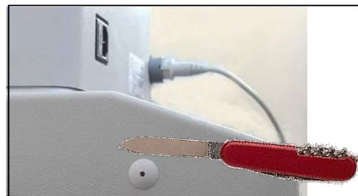
Abbildung G: Entfernung der Kunststoffstöpsel der hinteren Sockelverkleidung
