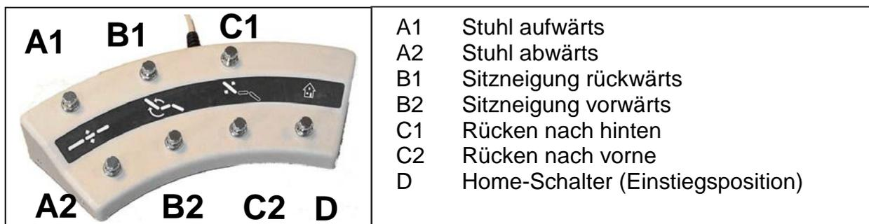
Abbildung M: Fußbedienung des Fußpflegestuhles S4.2.
