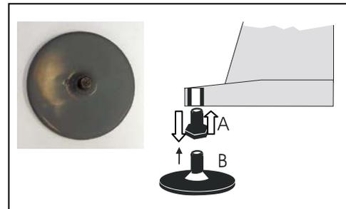
**Abbildung J: falls der Stuhl nicht am Boden verschraubt werden kann, sind Erweiterungsfüße zu empfehlen**
