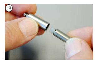
Schieben Sie die vormontierte Spannkammer in die Welle.
