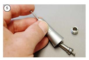
Entnehmen Sie die Spannkammer. Falls die Spannkammer nicht von allein aus dem Gehäuse gleitet, stecken Sie einen Prüfstift in das Handstück und schieben Sie damit die Spannkammer heraus.
