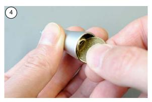
Schrauben Sie die Verschlussmutter mit Hilfe einer 10 Cent Münze heraus.
