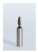
Stellen Sie die Prüflehre aufrecht hin und legen Sie eine Abtropfkappe ein. Schieben Sie dann den Fräser bis zum Anschlag in die Prüflehre. Die Abtropfkappe hat nun genau die richtige Position zur Verwendung in Ihrem GERLACH Fußpflegegerät.
