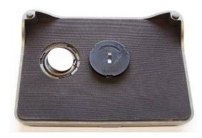
Auf der Unterseite des Fußschalters befindet sich der runde Batteriedeckel, der mit einer Münze oder einem geeignet großen Schraubendreher in Pfeilrichtung geöffnet wird. Nach dem Entfernen des Deckels und der alten Batterie, wird die neue Batterie mit dem Pluspol nach oben in das Fach eingelegt.
