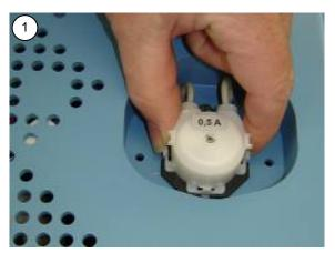
Drücken Sie mit beiden Fingern die beiden Schnappverschlüsse der Pumpenkassette gleichzeitig zusammen.
