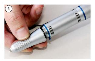
Schrauben Sie die Handstückspitze vom Motor. Achten Sie darauf, dass die graue Kunststoff Kupplung (a) auf der Motorwelle bleibt.
