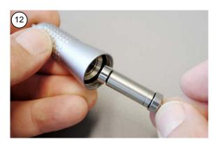
Schieben Sie nun die Welle mit der Spannkammer in das Handstückgehäuse.
