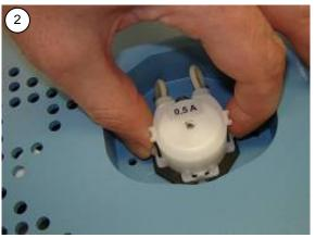
Sobald sich die Pumpenkassette vom Gehäuse gelöst hat, komplett nach oben abheben.
