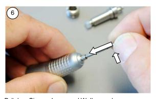
Drücken Sie nun Lager und Welle aus dem Handstückgehäuse. Stecken Sie dazu den Prüfstift leicht schräg in das Handstück, bis dieser auf die Vorderkante der Welle trifft, und drücken die Welle heraus.
