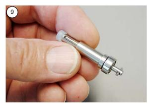
Bauen Sie die gereinigten und getrockneten Teile nun wieder zusammen. Stecken Sie zuerst die Spannbuchse (a) auf die dafür vorgesehenen Zapfen am Spannbett (b). Legen Sie nun die drei Spannstifte (c) ein und schieben die Teile gemeinsam in die Spannkammer (f).
