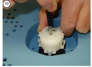
Stecken Sie eine dünne Pinzette in die Öffnung der Pumpenkassette und spreizen die Andruckrollen etwas auseinander. Schieben Sie jetzt die Pumpenkassette auf die Motorwelle und rasten sie im Gehäuse ein.
