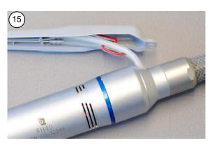
Achten Sie beim Montieren des Spraykanals darauf, dass das Kabel in einer Z-Form zwischen den beiden Sprayschläuchen liegt.
