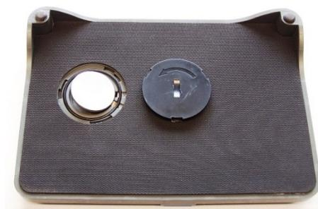
Auf der Unterseite des Fußschalters befindet sich der runde Batteriedeckel, der mit einer Münze oder einem geeignet großen Schraubendreher in Pfeilrichtung geöffnet wird. Nach dem Entfernen des Deckels und der alten Batterie, wird die neue Batterie mit dem Pluspol nach oben in das Fach eingelegt. Der Deckel wird auf das Batteriefach (in die drei Vertiefungen) gedrückt und entgegen der Pfeilrichtung wieder geschlossen.
