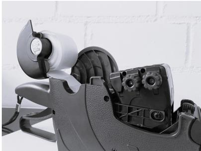
Legen Sie nun den Etikettenstreifen hinter die Alu-Transportrollen und betätigen Sie mehrfach den Hebel zum Etikettieren bis sich das Etikettenband einzieht und stramm sitzt. Nach mehrfacher Betätigung produzieren Sie die ersten Etiketten die sich selbstständig ausrichten.
