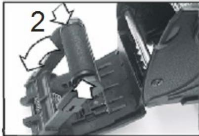
Sollte der Anpressdruck der Rolle nicht ausreichen, können Sie mit Hilfe eines Schraubenziehers die Druckeinheit nach vorne versetzen (siehe Abbildung).
