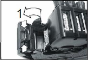
Drücken Sie die geriffelten Schenkel die sich am Farbwalzenhalter befinden zusammen und ziehen diese hoch. Tauschen Sie die Farbwalze aus und legen Sie diese wieder ein (einrasten). Verschließen Sie die den Walzenhalter.
