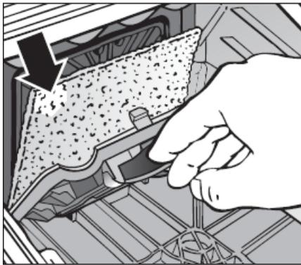
1. Öffnen Sie den Staubraumdeckel. Ziehen Sie den Staubbeutel an der Griffflasche aus der Aufnahme. Klappen Sie den Filterrahmen bis zum deutlichen Einrasten auf und nehmen Sie den verbrauchten Motorschutzfilter an der sauberen Hygieneffläche heraus.
