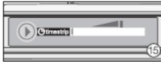
4. Nach ca. 10 - 15 Sekunden erscheint am linken Rand des Anzeigefeldes ein schmaler roter Farbstreifen. Schließen Sie den Staubraumdeckel bis zum deutlichen Einrasten.
