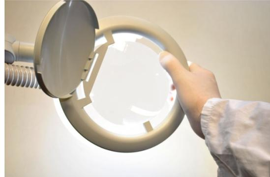
Sollten Sie im Laufe der Zeit feststellen dass Ihnen die Gelenke der Leuchte zu leichtgängig werden, dann können diese an der markierten Position von außen mittels eines 4 mm Inbusschlüssel (nicht im Lieferumfang enthalten) nachgestellt werden. Dabei ist zu beachten, dass sich der Leuchtenkopf mit einem geringen Widerstand bewegen lassen sollte.
