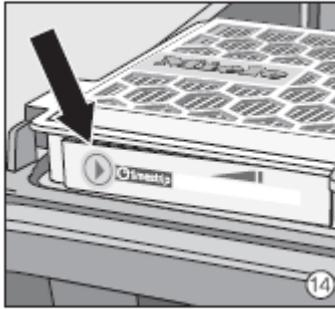
3. Drücken Sie die Abluftfilter-Wechselanzeige
