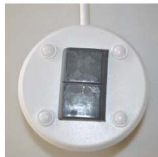
Kleben Sie unter den Schalterboden mittig die im Lieferumfang enthaltene Schalterunterlage. Dafür lösen Sie die beidseitige Schutzfolie vorher ab. Durch diese Schalterunterlage können Sie den Schalter in die gewünschte Position bringen und fixieren. Bei der Reinigung der Arbeitsplatte können Sie den Schalter problemlos lösen und danach wieder neu anbringen.
