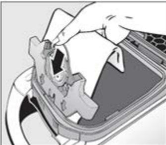
3. Stecken Sie den neuen Staubbeutel bis zum Anschlag in die **rote Aufnahme**. Lassen Sie ihn dabei so zusammengefaltet, wie Sie ihn der Verpackung entnehmen. Entfalten Sie den Staubbeutel im Staubraum so weit wie möglich. Schließen Sie den Staubraumdeckel bis zum Einrasten der Verriegelung und achten Sie darauf, dass der Staubbeutel dabei nicht eingeklemmt wird.
