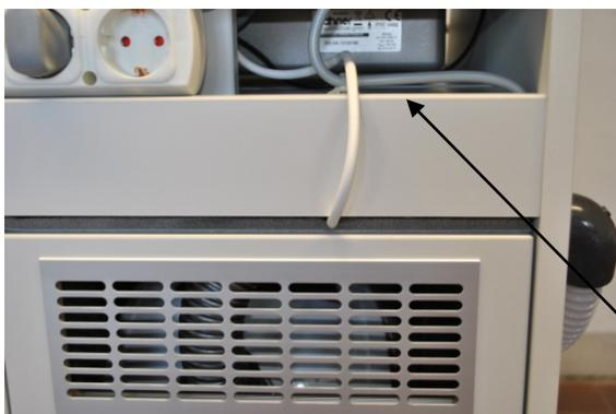
Die leistungsstarke Absaugeinrichtung wird durch einen zusätzlichen, frei positionierbaren Schalter ein- und ausgeschaltet. Dieser Schalter ist bereits im Staubsaugerfach vormontiert platziert.
