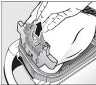
2. Ziehen Sie den Staubbeutel an der Griffflasche aus der Aufnahme.
