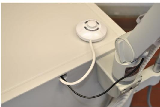
Sollten Sie den Schalter als Handschalter benutzen wollen, führen Sie bitte das Schalterkabel von hinten durch den Schrank, so dass sie es seitlich aus der Öffnung wieder herausführen können. Hierbei können Sie auch gleichzeitig das Anschlusskabel der Leuchte durch den Schrank nach hinten führen und seitlich am Gerät ablegen. Somit stören Sie die Kabel nicht während Ihrer Arbeit.
