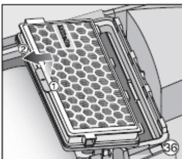
1. Öffnen Sie den Staubraumdeckel. Heben Sie den Abluftfilter an und entnehmen Sie ihn.
