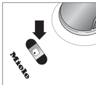
Wenn die Farbskala das Sichtfenster der Staubbeutel-Wechselanzeige rot ausfüllt, müssen Sie den Staubbeutel austauschen.
