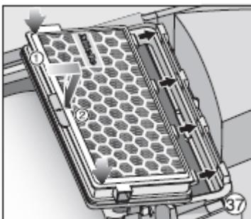
2. Setzen Sie den neuen Abluftfilter passgenau ein und drücken Sie ihn nach unten.
