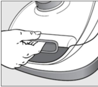
1. Schlauchstutzen vom Staubsaugergehäuse lösen.
