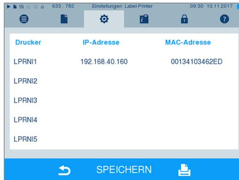
7. Wählen Sie den Label-Printer aus der Druckerliste aus und bestätigen Sie mit [SPEICHERN]. Das Display wechselt wieder in das Label-Printer Fenster.
