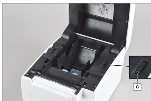
3. Nehmen Sie die Etikettenrolle mit den schmalen Etiketten (5 cm breit) und setzen Sie sie mittig in den Rollenhalter.
