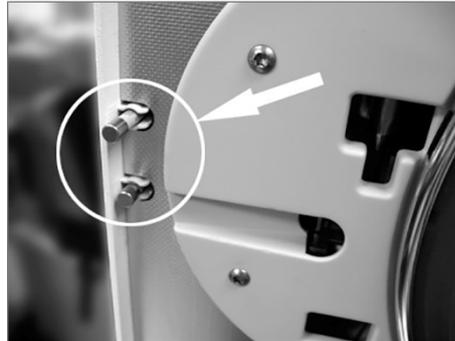
4. Ziehen Sie die defekten Gerätesicherungen heraus und stecken Sie die neuen Ersatzsicherungen fest in die Sicherungshalter ein.
