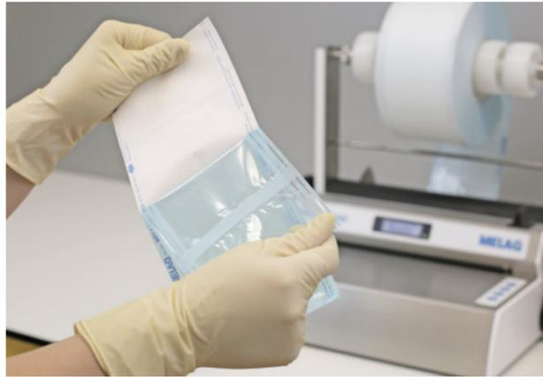
Führen Sie bitte **täglich** vor Arbeitsbeginn eine Probesiegelung durch. Die Siegelnaht muss gleichmäßig und vollständig ausgeprägt sein.
